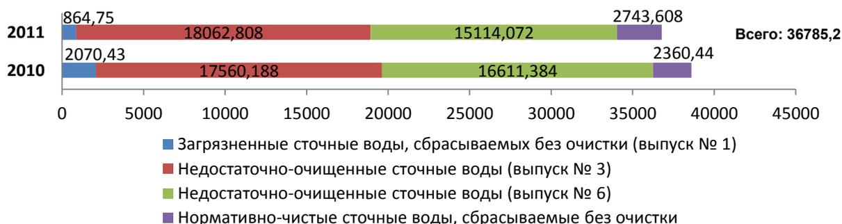
Рис. М5.1. Объемы сброса сточных вод ОАО "Ковдорский ГОК" в 2010 и 2011 годах.
